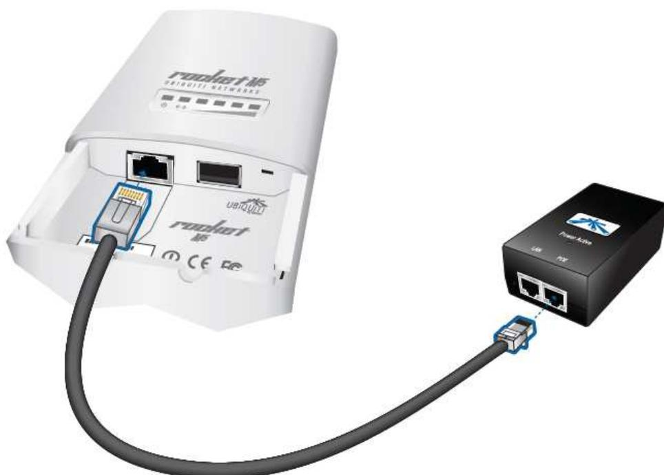
3. Подключите Ethernet- кабель от LAN-адаптера к Ethernet- порту, обозначенному **LAN** на блоке питания с технологией PoE.
