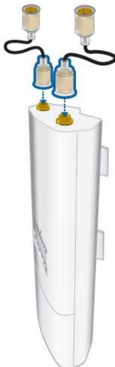
2. Вставьте RocketM в крепление на антенне. (Если монтаж RocketM производится на трубу, то перейдите к разделу «Монтаж на трубу» на стр. 5).
