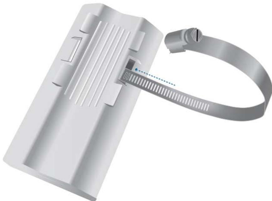
3. Оберните *металлический хомут* вокруг трубы и с помощью плоской отвертки затяните фиксирующий винт, поворачивая его по часовой стрелке.
