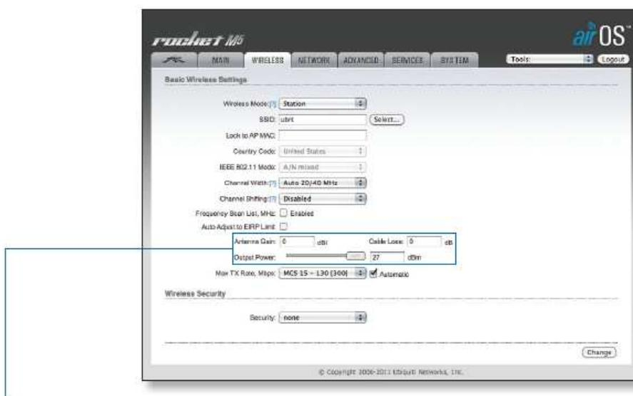
Поскольку к оборудованию Ubiquiti Networks могут подключаться различные антенны и кабели, то для соблюдения специальных нормативных требований в качестве вспомогательной информации предусматриваются поля *Antenna Gain* (Коэффициент усиления антенны), *Cable Loss* (Потери в кабеле) и *Output Power* (Выходная мощность).
