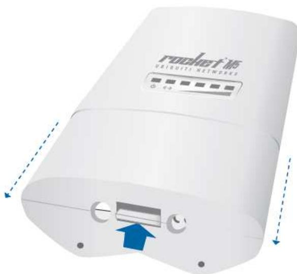
2. Соедините Ethernet- кабель с Ethernet-портом и с разъемом, обозначенным **POE** на блоке питания с технологией PoE.
