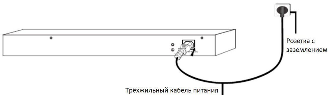
Рисунок 2.8 Заземление с использованием трёхжильного кабеля питания
