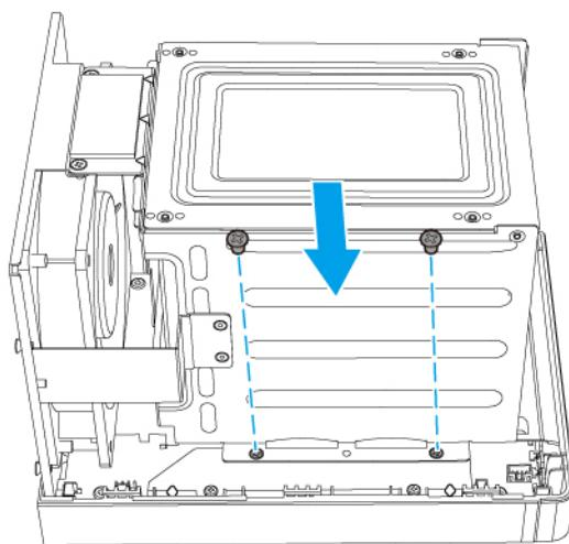
**14.** Прикрутите винты сверху и снизу с тыльной части NAS.
