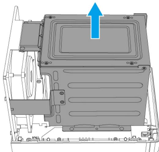
**10.** Снимите установленный модуль.
