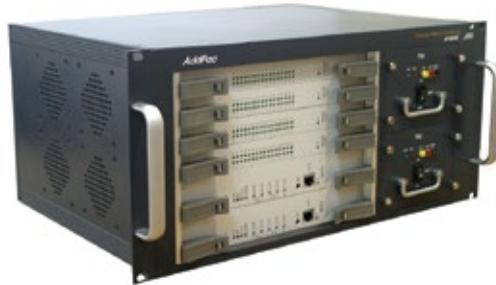
Шасси **AP6800** имеет 8 слотов для установки карт AP-N1-FXS32/ AP-N1-FXO32 (до 256 аналоговых интерфейсов) и процессорные карты-контроллера с поддержкой горячей замены. Питание осуществляется от двух блоков питания AC/DC на передней панели.
