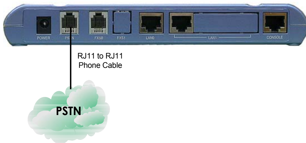
Рисунок 3-4: Соединение VoiceFinder AP200 и телефонной линии ТфОП
