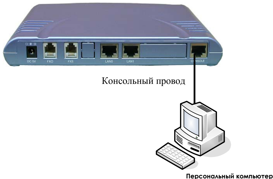
Рисунок 3-1: Соединение VoiceFinder AP200 и ПК для консольного управления
